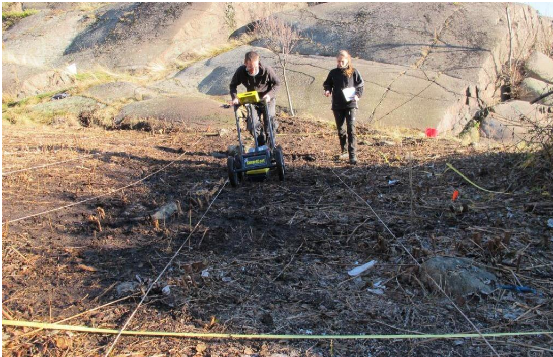
Figur 8. Lars Gustavsen og Monica Clausen fra NIKU kjører georadar over et målesystem. Foto V.L.
