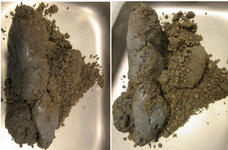
Figur 15 Bilde punkt 3 (1 – 2 m dybde) viser overgang sand/silt
