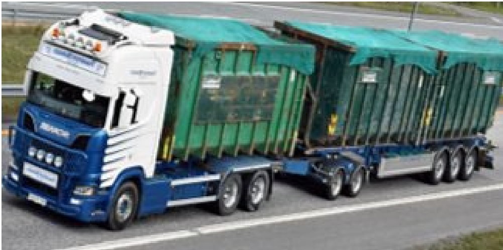
Modulvogntog type 1 (den mest brukte i Norge). Trekkvogn med dolly og semitrailier. Lengde opp til 25,25 og totalvekt opp til 60 tonn totalvekt.
