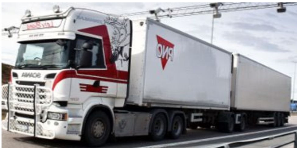
Modulvogntog type 3. Trekkvogn med spesiell semitrailer med kort skap/container i front og svingskive bak. Lengde opp til 25,25 og totalvekt opp til 60 tonn. Dårligere sporing enn type 1 og 2 og begrenset fremkommelighet på smale, svingete veier, krever mer plass i kryss, rundkjøringer og avkjørsler.
