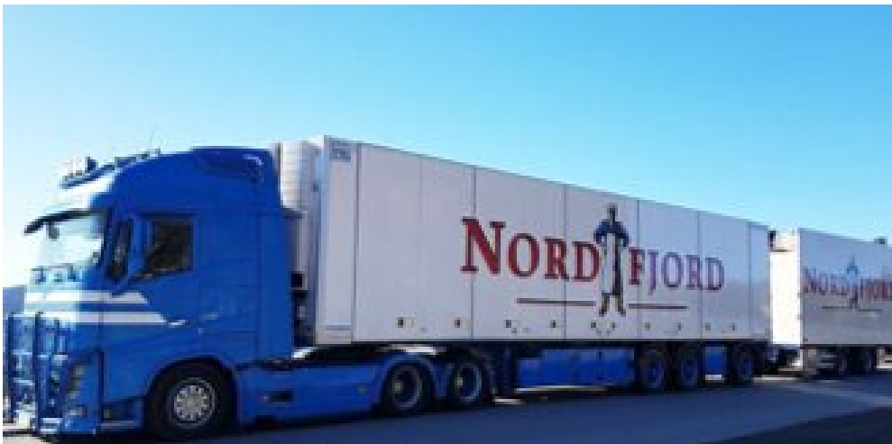
Modulvogntog type 2. Trekkvogn med semitrailer og påhengsvogn. Lengde opp til 25,25 og totalvekt opp til 60 tonn totalvekt.
