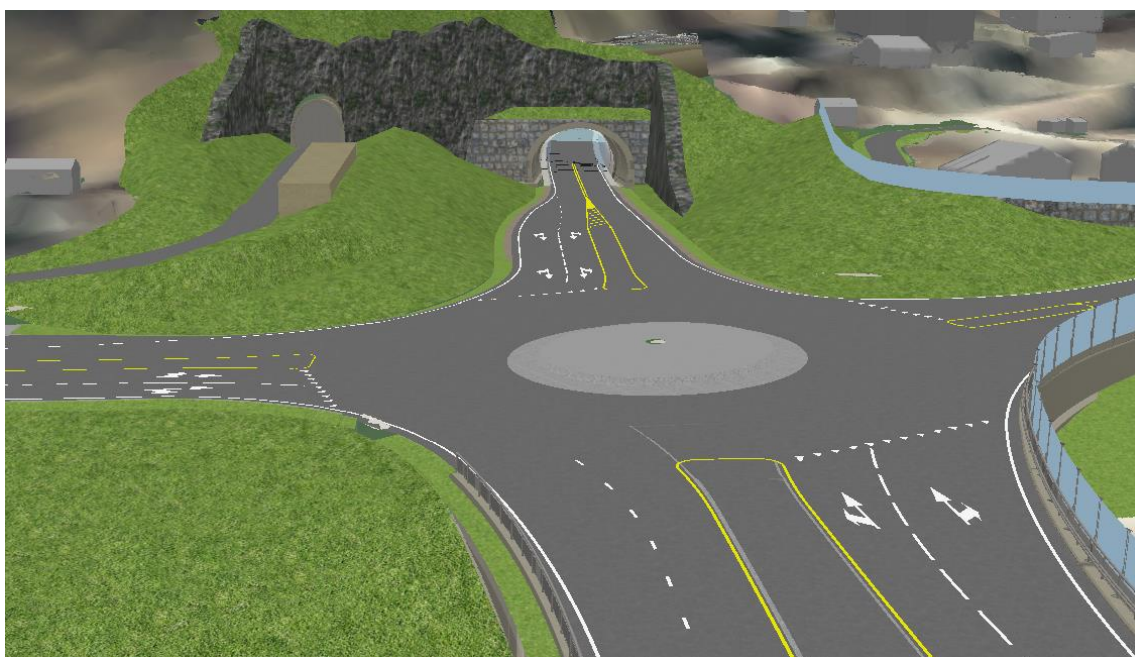
Figur 5-16 Portal, Teietunnelen fra Ramdal. Rømningstunnel og teknisk bygg til venstre.
