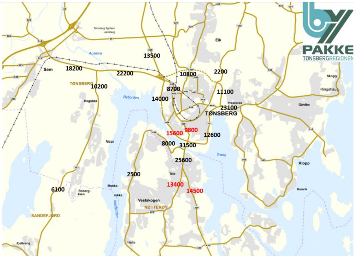
Figur 4-13 Dagens trafikk Smidsrødveien har ÅDT 10700 i 2019. (Statens vegvesen region Sør, 2017)
